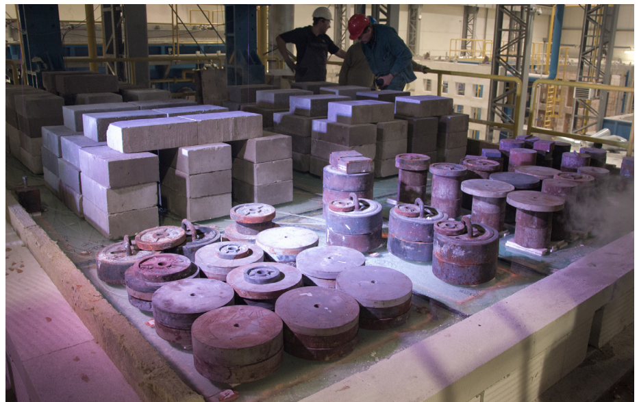
Na obrázku: strop se sklem Polflam nad komorou zkušební pece během zkoušek protipožárních vlastností v certifikačním institutu. V konstrukci stropu byly použity skleněné prvky různých rozměrů a tvarů, které byly vystaveny zátěži v souladu s požadavky normy.
