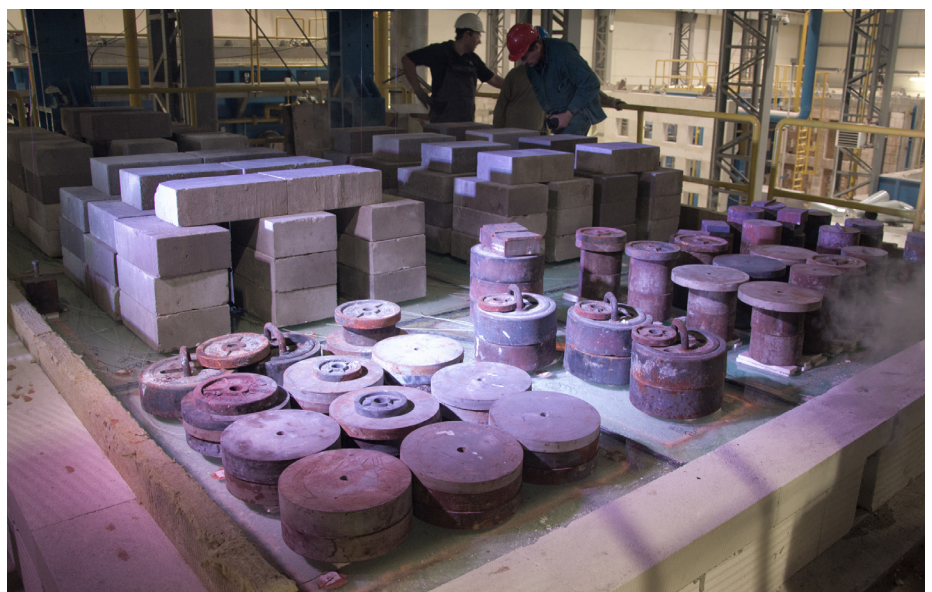
Das Bild zeigt eine Decke mit POLFLAM®-Brandschutzglas über der Kammer eines Prüfofens während der Feuerwiderstandsprüfung in der Zertifizierungsstelle. In der Deckenkonstruktion wurden Glaselemente verschiedener Größen und Formen eingesetzt, die gemäß den geforderten Normen belastet werden
