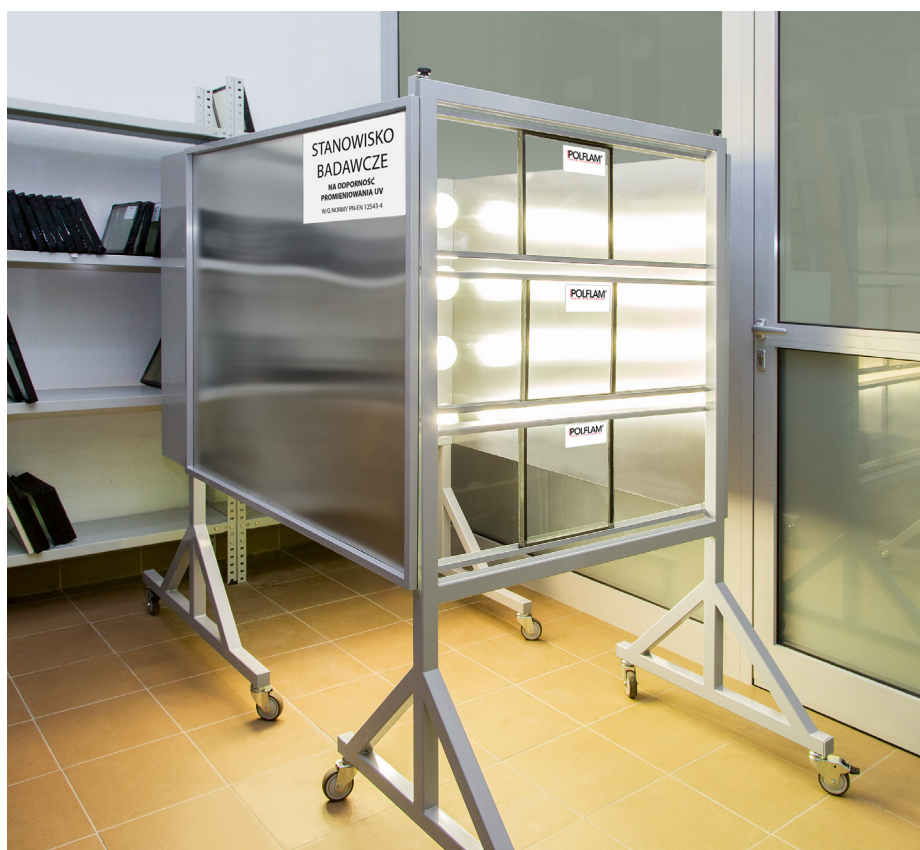
W zakładowym laboratorium szkło Polflam poddawane jest długotrwałemu działaniu promieni UV.
