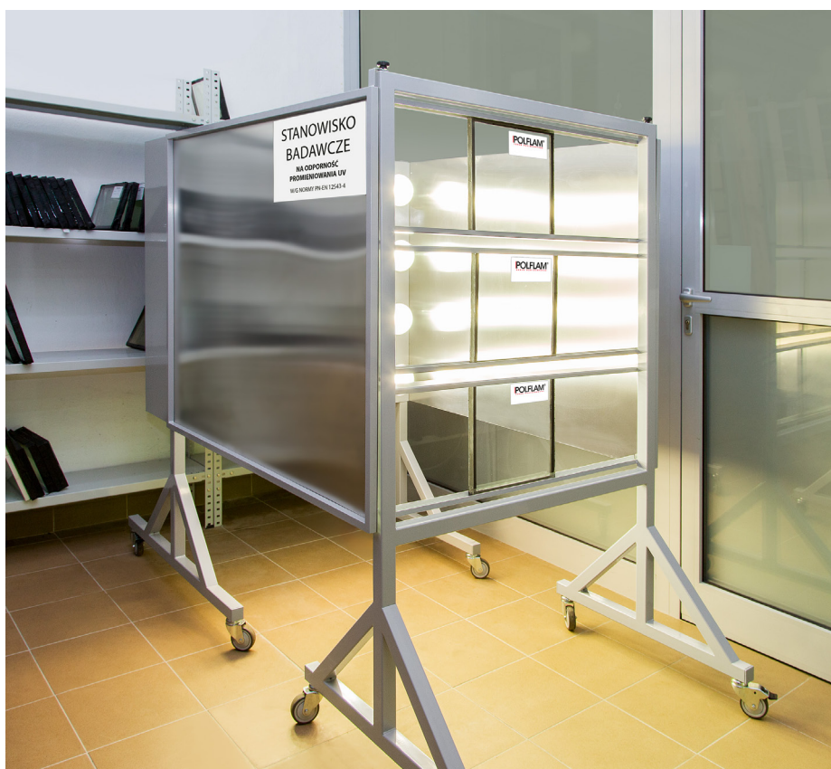
V podnikové laboratoři značky Polflam je sklo podrobováno působení UV záření.
