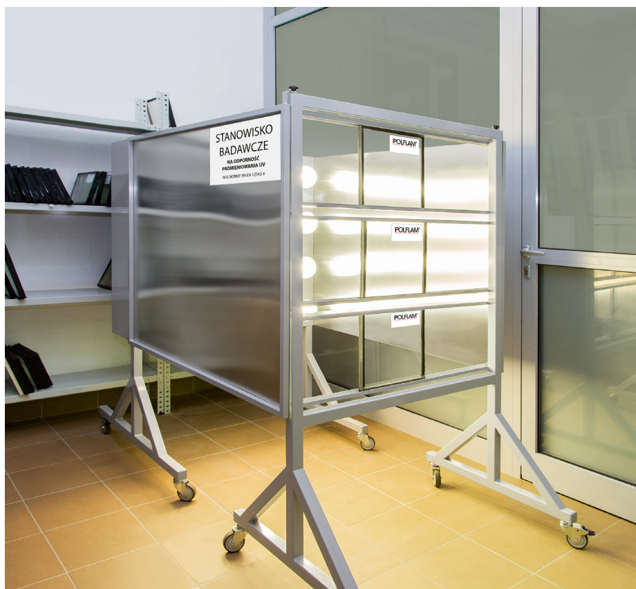
В заводской лаборатории марки Polflam стекло подвергается воздействию ультрафиолетовых лучей.
