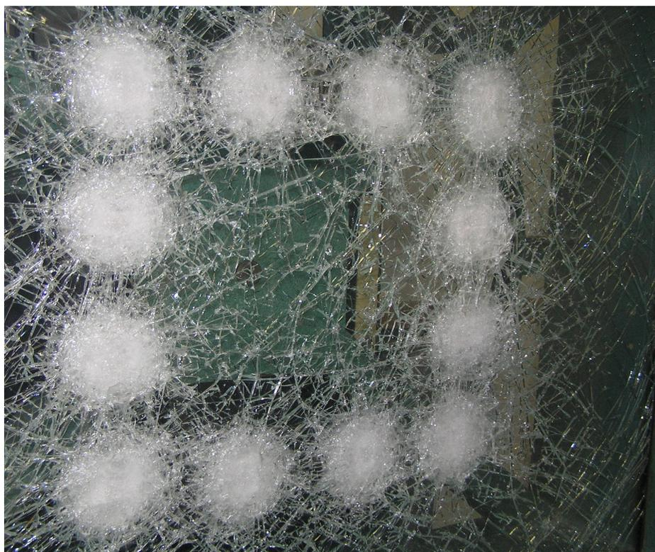
Um die erhöhte Sicherheitsklasse zu erzielen, wird das Glas mit einer hitzehärtbaren Folie laminiert, die optimale Parameter in Bezug auf Robustheit, Witterungsbeständigkeit und UV-Schutz gewährleistet. Ebenso wie das Floatglas, aus dem POLFLAM<sup>®</sup>-Produkte entstehen, weist auch das Multifunktionsglas herausragende optische Eigenschaften auf. Da die Folien in einer großen Farbpalette
