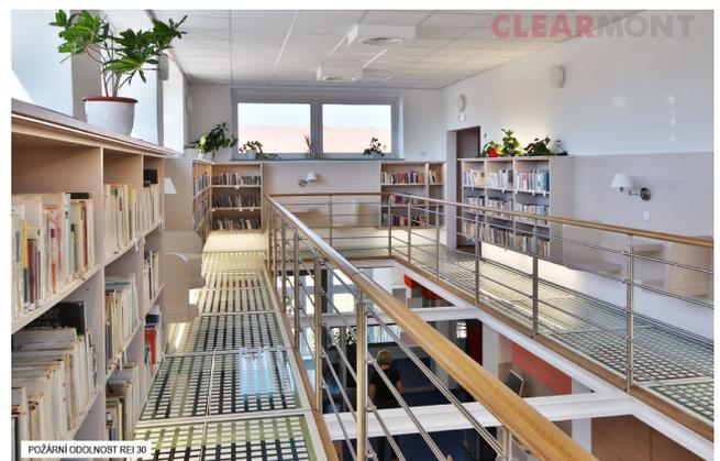
Feuerfeste Deckenverglasungen ermöglichen die Ausleuchtung selbst von für natürliches Licht schwer erreichbaren Innenbereichen wie Treppenhäusern, Innenhöfen oder Räumen im Untergeschoss. Das Bild zeigt das Brandschutzglas POLFLAM® F der Klasse REI 60 in den Glasdecken auf zwei Stockwerken im Treppenhaus der Oskar-Kolberg-Musikschule in Szczecinek.
