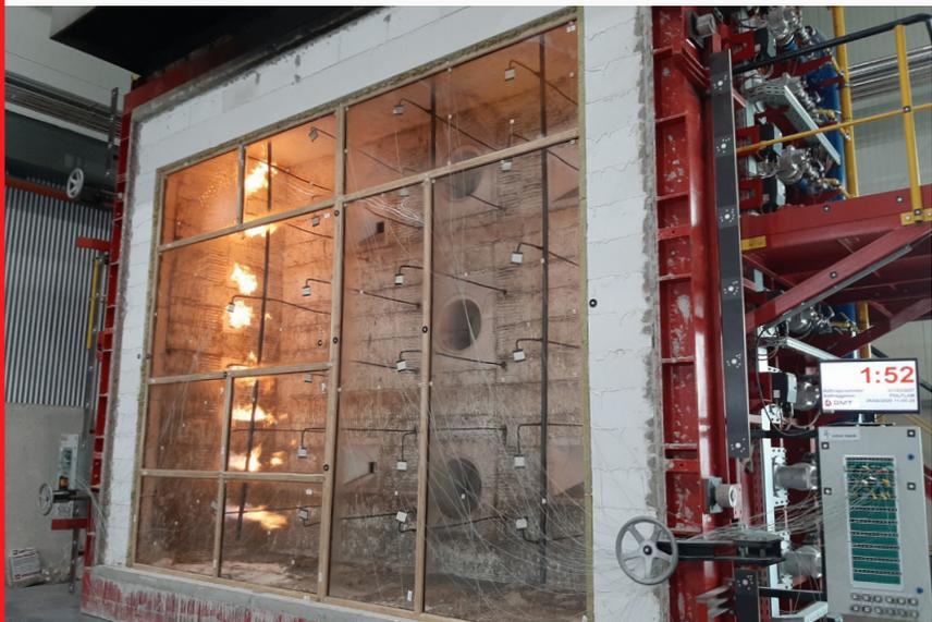
Das POLFLAM-Werk verfügt mit einem Ofen zur Durchführung von Feuerwiderstandsprüfungen über die technischen Möglichkeiten, neue Lösungen gemäß europäischen Normen zu testen.
