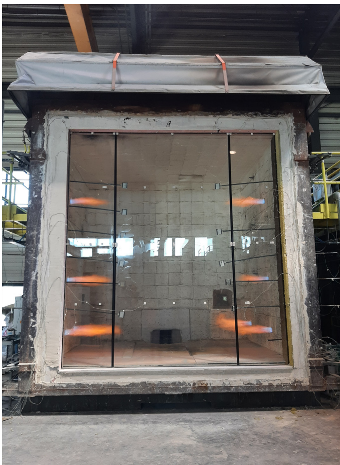
Bei hohen Temperaturen verändern sich Struktur und Aussehen des POLFLAM®-Brandschutzglases, doch seine Form bleibt erhalten. So bildet es über 120 Minuten lang eine stabile Barriere gegen Feuer und Wärmestrahlung. Prüfung erfolgreich bestanden – mit einer deutlichen Überschreitung der für die Klassifizierung geforderten Zeitdauer. ▶
