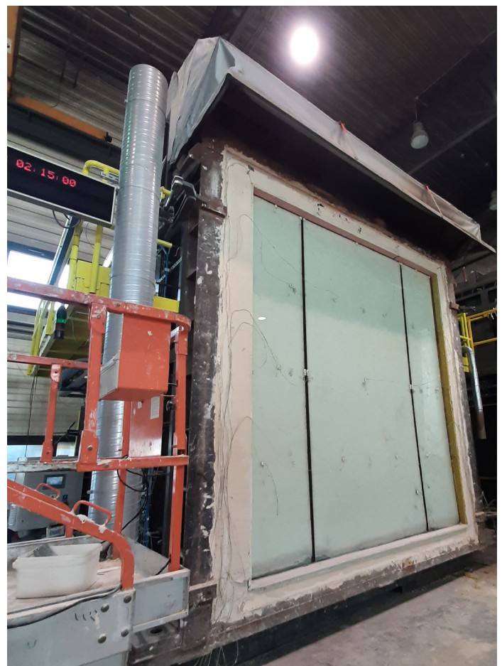
Bei hohen Temperaturen verändern sich Struktur und Aussehen des POLFLAM®-Brandschutzglases, doch seine Form bleibt erhalten. So bildet es über 120 Minuten lang eine stabile Barriere gegen Feuer und Wärmestrahlung. Prüfung erfolgreich bestanden – mit einer deutlichen Überschreitung der für die Klassifizierung geforderten Zeitdauer. ▶
