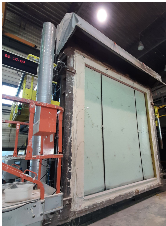
Élément en verre de protection incendie POLFLAM BR EI 120 de grand format pendant les premières minutes du test dans le laboratoire de Gryfitlab.
