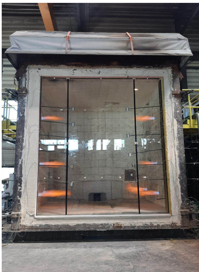
Élément en verre de protection incendie POLFLAM BR EI 120 de grand format pendant les premières minutes du test dans le laboratoire de Gryfitlab.
