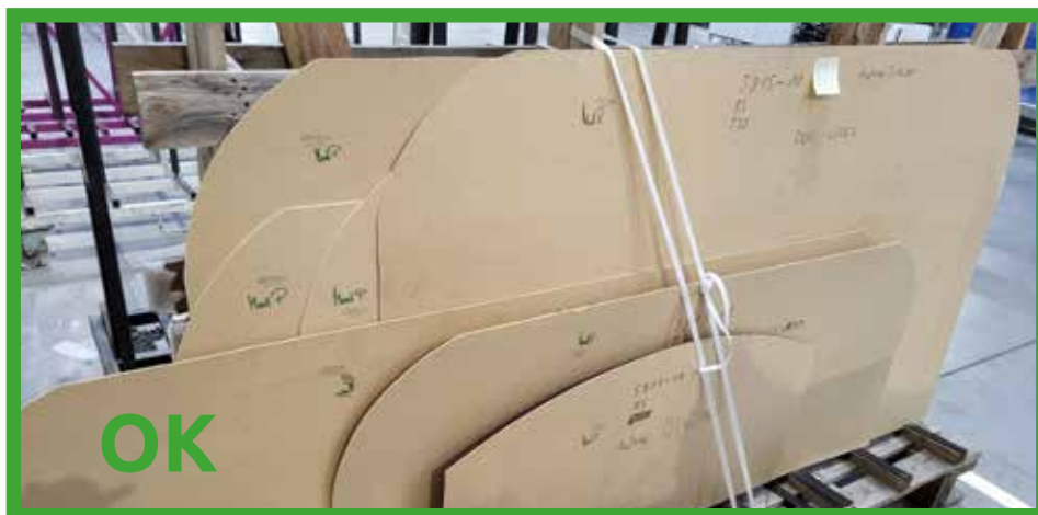
Obr. 1. Nahoře: Nepřijatelné výřezy – nepravidelné a nevhodné k digitalizaci. Dole: Přijatelné výřezy – čisté tvary v HDF, připravené k přesnému zpracování.
