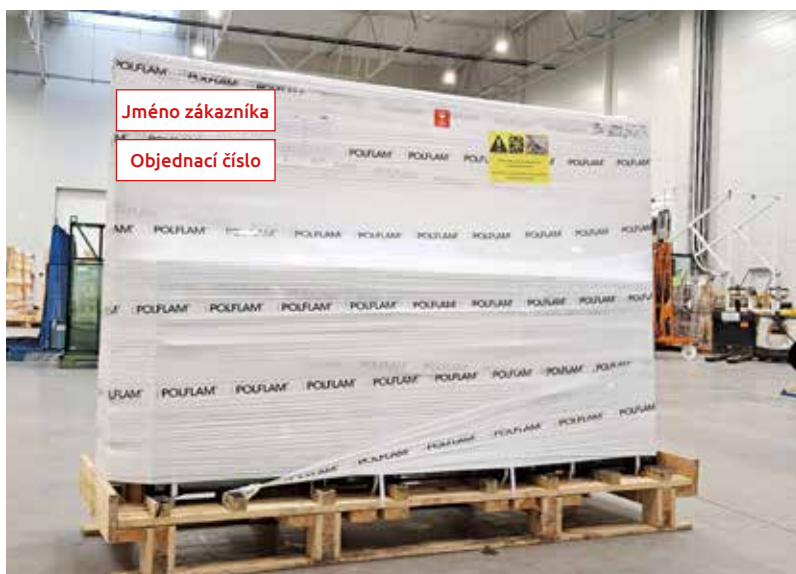
Obr. 2. Bezpečně zabalené a zajištěné protipožární sklo POLFLAM zabalené napínací fólií.
