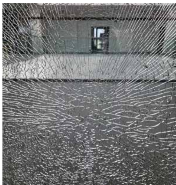
Obr. 9. Tepelně tvrzené sodnovápenaté bezpečnostní sklo vyrobené horizontálním tvrzením.
